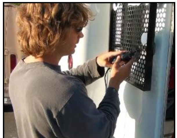
Timothy cortando una sección de la placa de metal para acceder a la manivela de la puerta en la puerta trasera.
